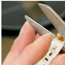
Einfache Montage: LED-Band ist an der markierten Stelle mit Schere trennbar.
